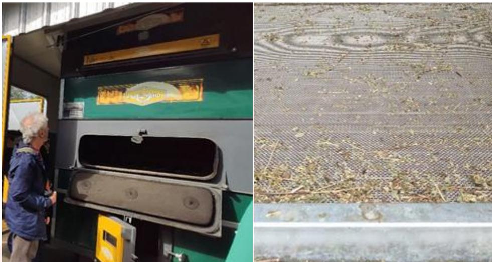
*Détail de la chaudière et du fond perforé de la chambre de séchage*
