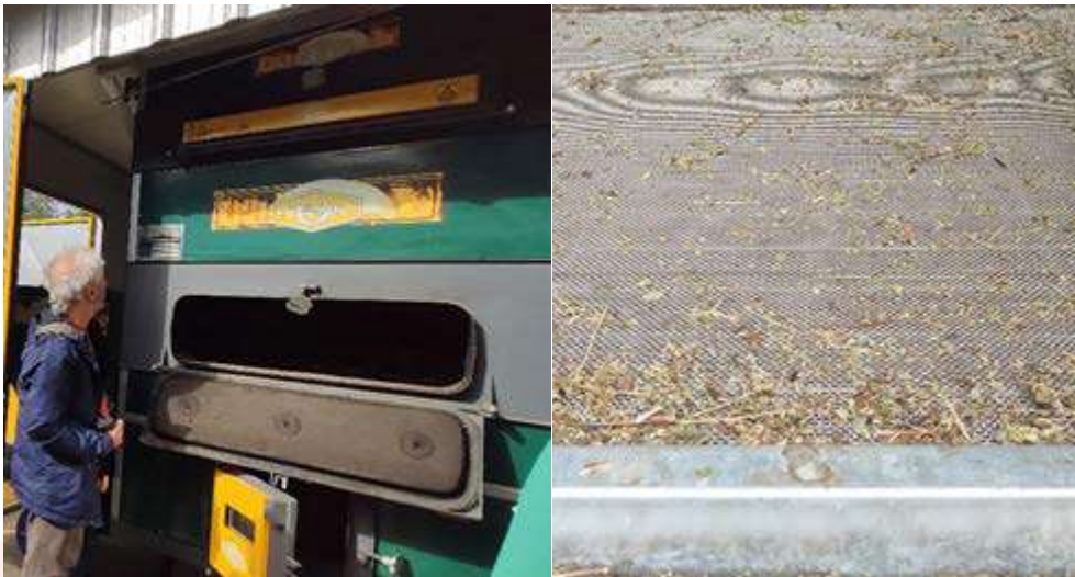
Detall de la caldera i del terra perforat de la cambra d'assecatge
