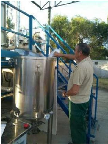
*Détail de l'alimentation du réservoir de dissolvant (éthanol 99 %).*
