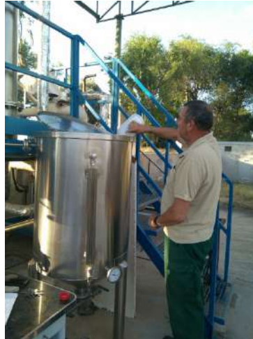
Detall de l'alimentació del tanc de dissolvent (etanol 99%).
